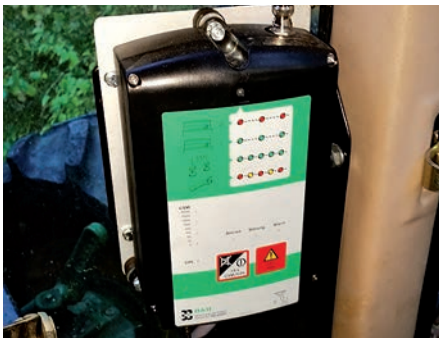
Platzsparend: Funkempfänger und Notrufmodul in einem Gehäuse
