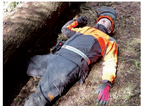
Hier würde der Lagesensor auslösen, bei Ohnmacht auch noch der Bewegungssensor.
